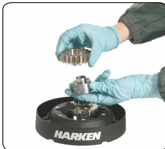
13. Remove the pawls carrier n°7
