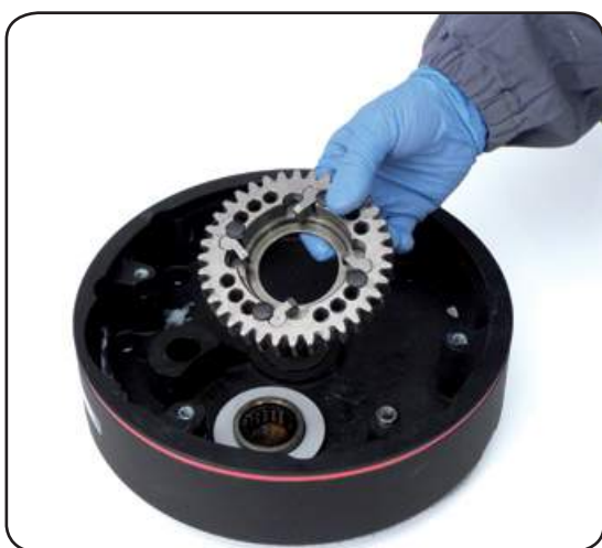
22. Remove the gear n°14
