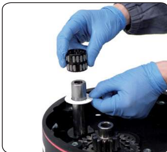
19. Slide out roller bearings n°6 and washer n°8
