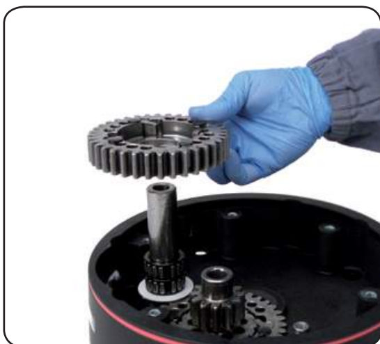
18. Slide out the gear n°10
