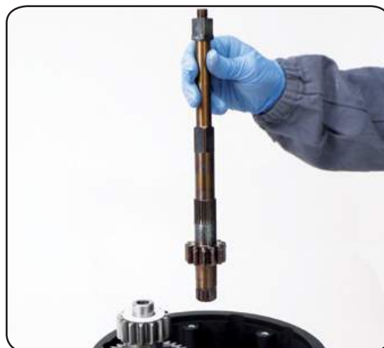
13. Slide out the shaft n°28
