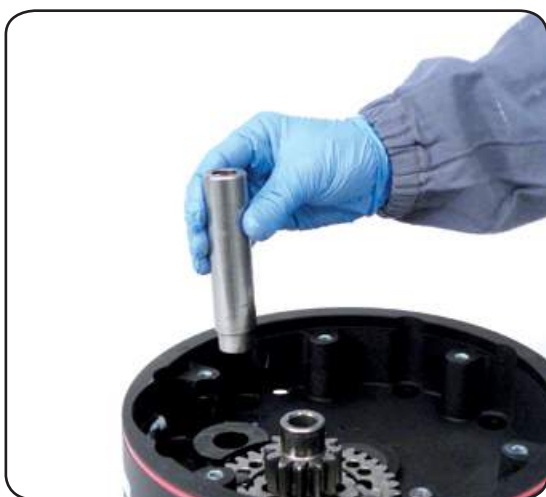
20. Remove the shaft n°7
