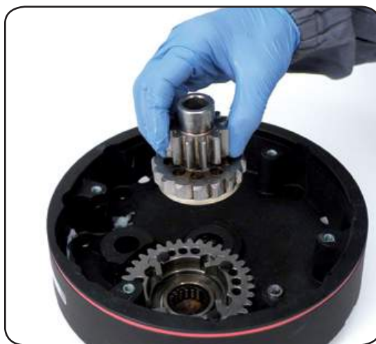
21. Remove the pinion n°13
