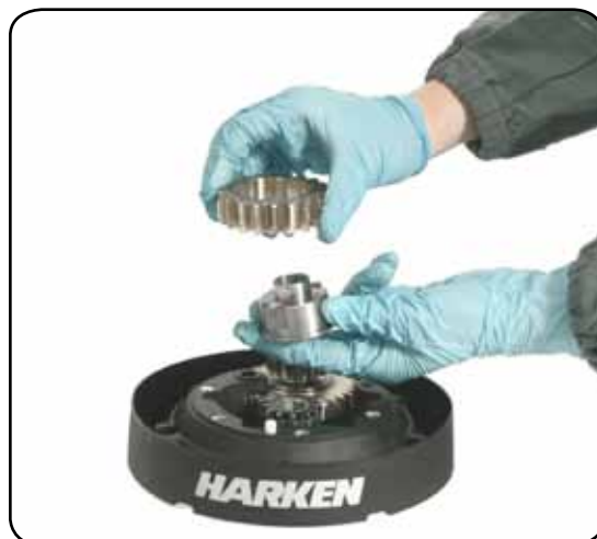
13. Remove the pawls carrier n°7
