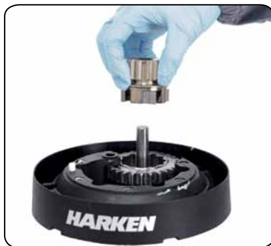
15. Remove the pinion n°11.
