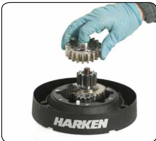
12. Remove the gear n°10
