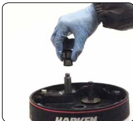
18. Remove roller bearings n°15
